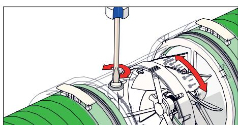
Stellen Sie den Volumenstrom durch Drehen des Drosselventils mit einem Schraubenzieher ein. Um eventuelle Messabweichungen zu vermeiden, erhöhen und reduzieren Sie den Luftvolumenstrom im Bereich des gewünschten Wertes, bis sich dieser stabilisiert.
