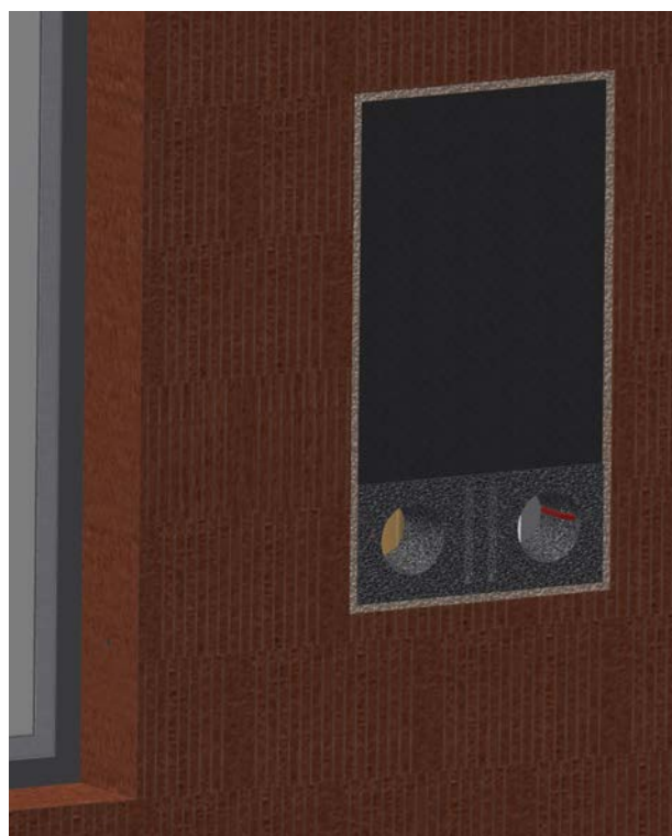
Traversée de mur à fleur par rapport à la maçonnerie
