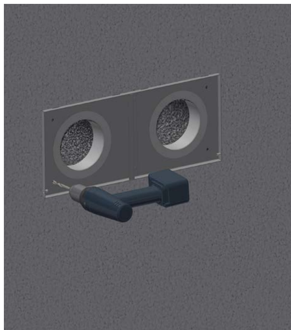
Prépercer la traversée de mur EPP au moyen d'un foret de 6 mm
