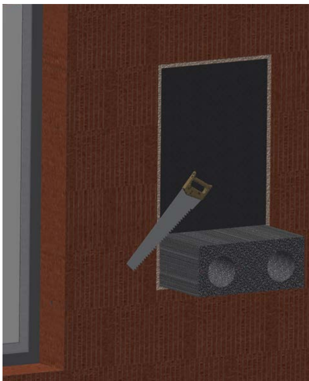
Découpe de la traversée de mur
