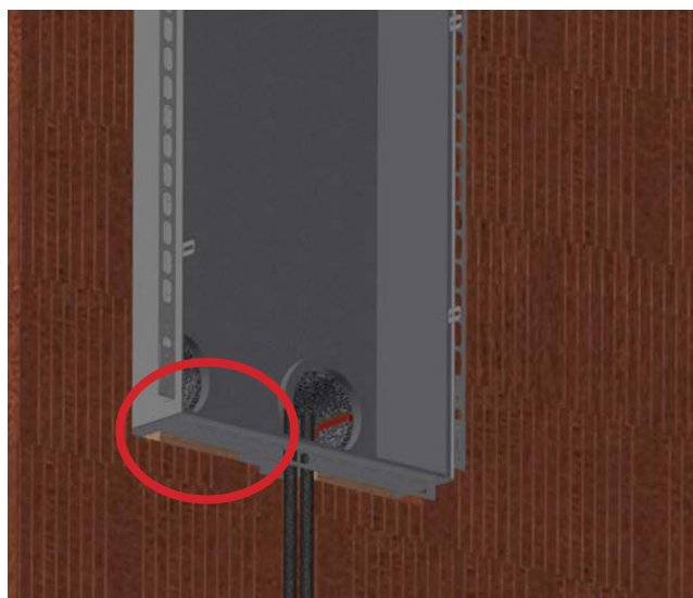
Mise en place des cales
