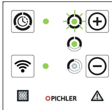
Niveau de ventilation 2 Le mode de ventilation intensive pour une durée définie
