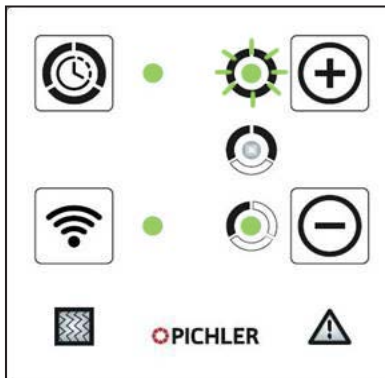
Niveau de ventilation 1 Le mode de ventilation intensive pour une durée définie
