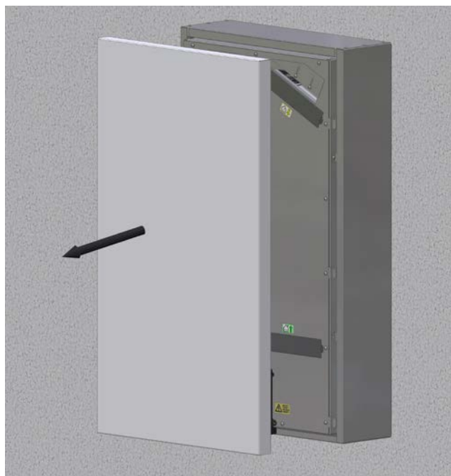
Ouvrir la tôle d'étanchéité
