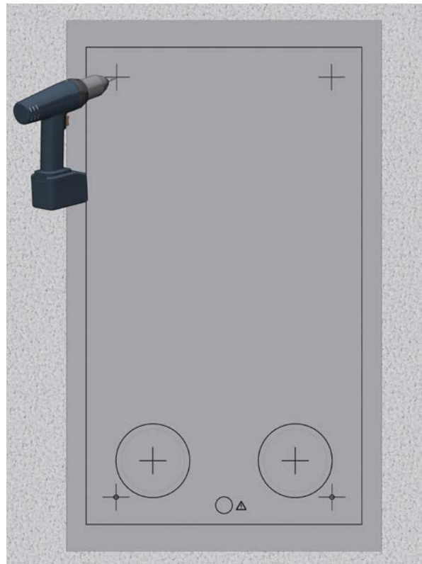
Perçage des trous
