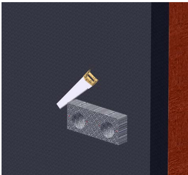
Skracanie przepustu ściennego
