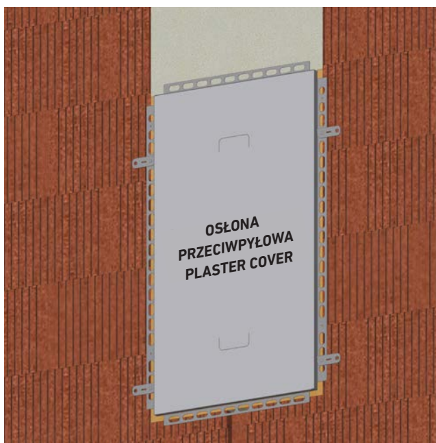
Wypełnianie pustych przestrzeni zaprawą - przyłącza u góry
