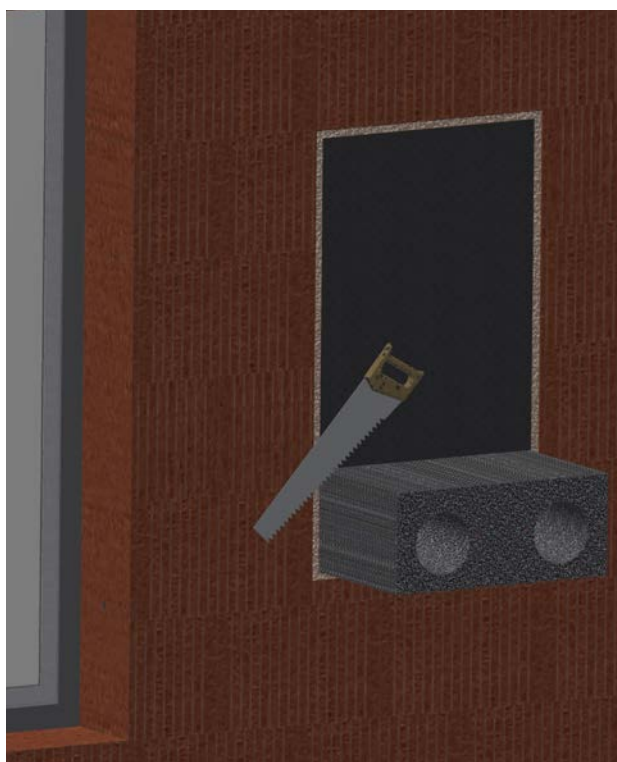
Skracanie przepustu ściennego
