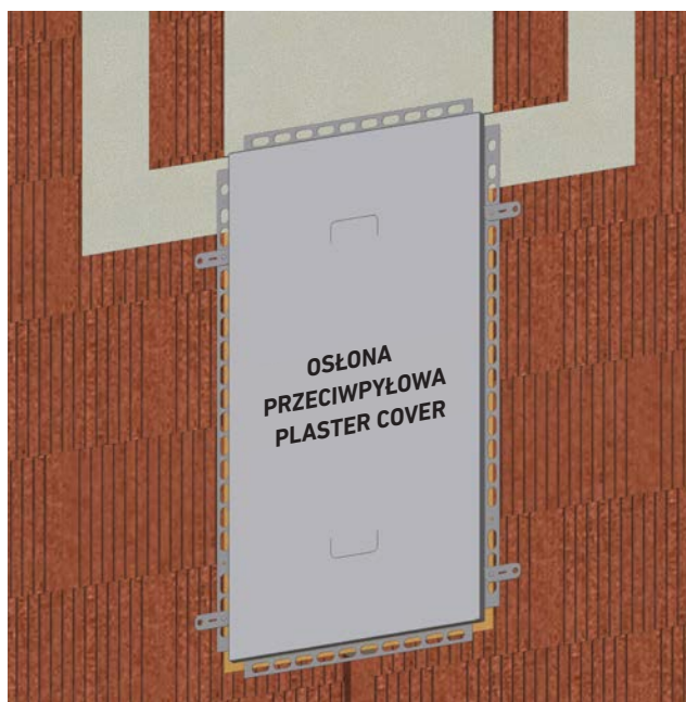
Wypełnianie pustych przestrzeni zaprawą - przyłącza z boku
