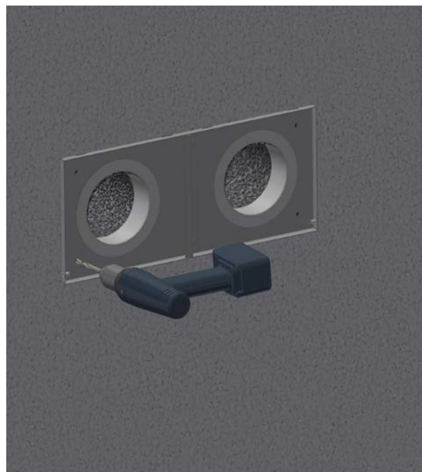
Wiertłem 6 mm nawiercić przepust ścienny EPP
