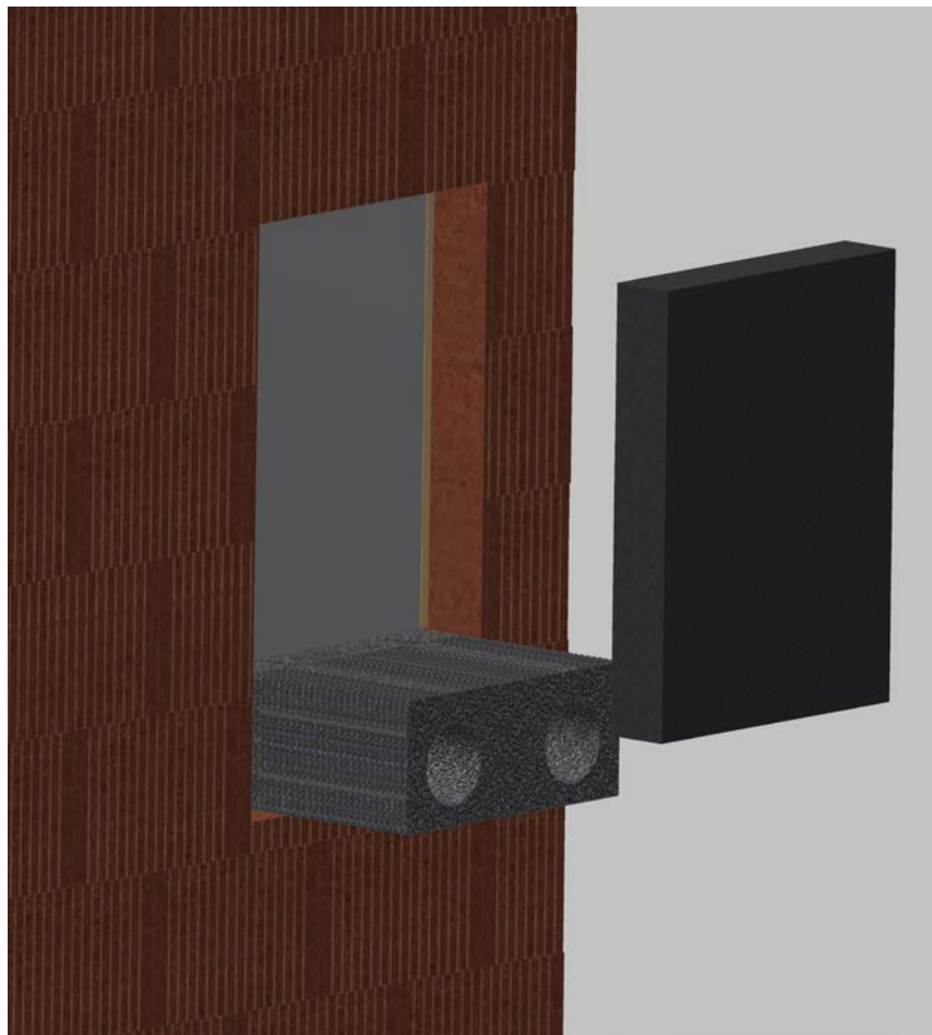
Przyklejanie izolacji wyrównawczej pianką klejącą WDVS
