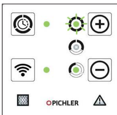
Nivel de ventilación 1 Modo ventilación intensa durante un tiempo definido
